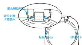
2.将下烤盘前端两定位对准卡槽装入，轻轻向下压，烤盘可锁紧。
