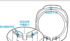
2.将上烤盘前端两定位对准卡槽装入，轻轻向下压，烤盘可锁紧。
