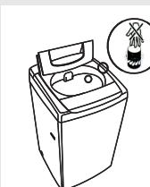
请勿安装在潮湿、雨淋的环境中,以免引起触电、起火、故障、变形。
