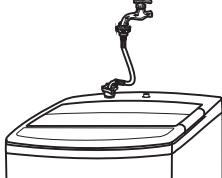
请使用机器附带的新软管组件, 旧软管组件不能重复利用。
