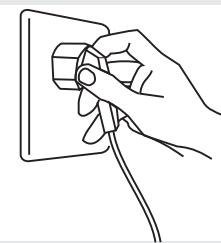
定期擦拭电源插头上的灰尘及污垢，以防接触不良。
