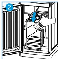
倒完内部浓缩水后,将排水箱放置回原位,排水图标熄灭。如果排水箱未放置到位,排水图标会持续亮起,且不能取用水。
