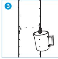
3 准备一个接水容器，旋开机器背面的排水阀，拔出排水塞，待水排干后，重新装好排水塞。
