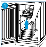
斜向上往外提出排水箱,将排水箱内部的浓缩水倒出用作拖地、浇花等生活用途。
