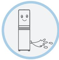
长时间不使用时，请把后部的排水阀打开将水排净，避免冰胆、水管内积存的水变质或因结冰导致零部件损坏
