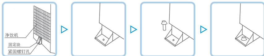
从内胆里的说明书包装袋中取出固定块和螺钉，用螺钉将固定块固定于净饮机底座后部中间位置，再将净饮机固定在地面。
