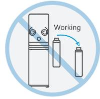
机器工作期间，请勿更换滤芯，更换滤芯时，请经由机器背面排水阀将机器内部的水排尽，并根据控制面板提示进行更换滤芯操作
