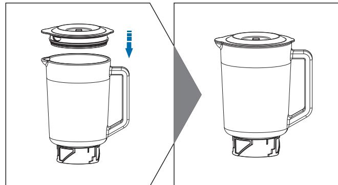
**4** 将小量杯旋入杯盖中，组成搅拌杯组件。
