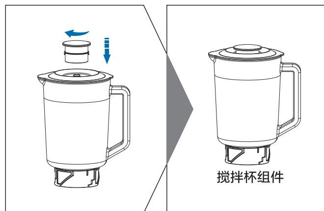
**5** 将安装好的搅拌杯组件旋紧到杯座中（听到咔嗒一声后才安装到位）。
