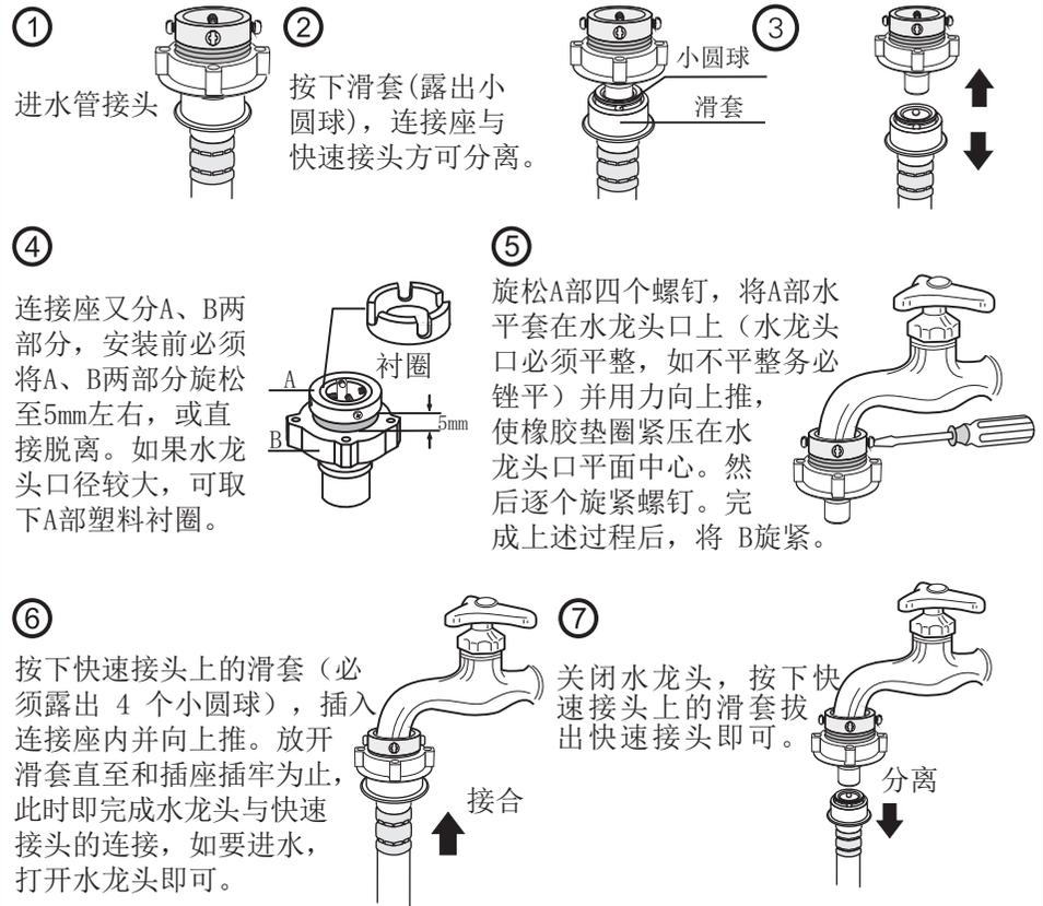
④ 连接座又分A、B两部分，安装前必须将A、B两部分旋松至5mm左右，或直接脱离。如果水龙头口径较大，可取下A部塑料衬圈。
