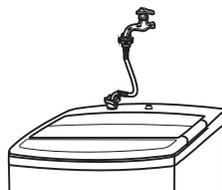
请使用机器附带的新软管组件, 旧软管组件不能重复利用。
