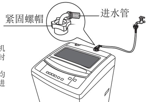
将进水管的另一端旋紧在洗衣机进水阀接头上。（内有橡胶密封垫圈）
