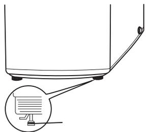
(首先略倾斜洗衣机, 放松调节脚旋钮, 调整调节脚使洗衣机底角皆与地面良好接触, 然后旋紧调节脚旋钮, 使之锁定。若地面明显不平, 需修正地面, 否则会导致洗衣桶倾斜, 出现撞击箱体现象。)
