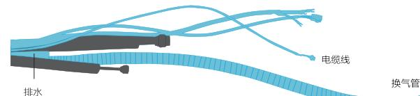
1. 将连接管平铺在地板上 - 将排水管、换气管、各种电缆线（必须将两端的插接端口整理正确）铺在连接管周围。
