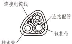
⑧按电源线、信号线在上侧，连接管在中间，水管在下侧的顺序进行包扎（连管接头处先不包扎，待连管完成，检漏确认后再进行包扎），再一起放到掰掉挡块的缺口中，然后装上两个后盖板，并用螺钉固定。
