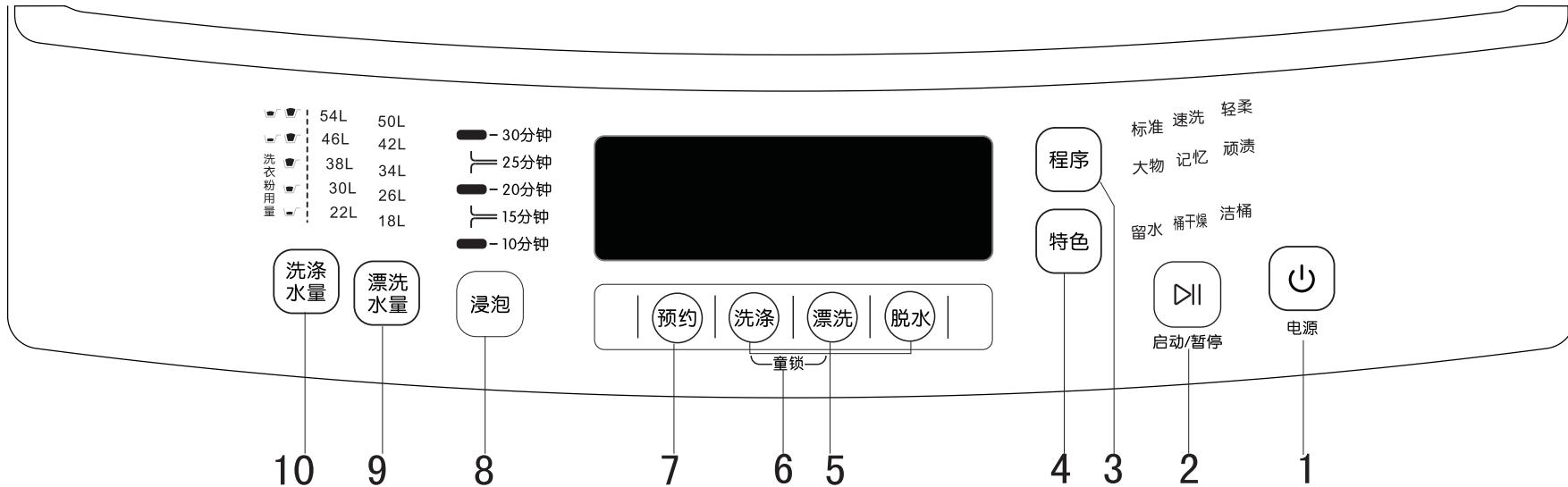
1. 电源开关，连续按该键，即为打开电源和关闭电源。
