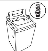
请勿安装在潮湿、雨淋的环境中，以免引起触电、起火、故障、变形。
