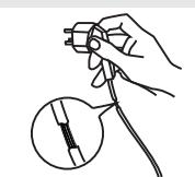
定期擦拭电源插头上的灰尘及污垢，以防接触不良。
