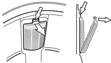
按上图箭头所示向下施压并向外拉，即可卸下过滤网架。
