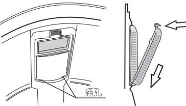
将过滤网架按上图箭头所示，向下插入两个插孔并用力推入，即可装上。
