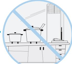
切勿在空调风直接吹到的地方使用燃烧器具
