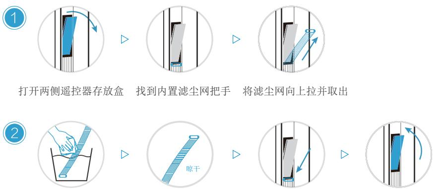
打开两侧遥控器存放盒 找到内置滤尘网把手 将滤尘网向上拉并取出
