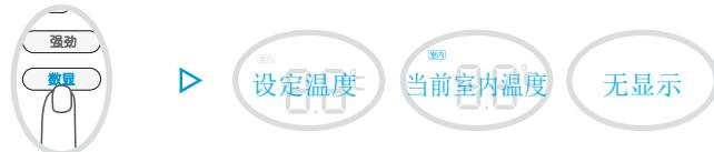
依次按遥控器“数显”键 空调器控制面板将依次显示“设定温度”、“当前室内温度”、“显示熄灭”。
