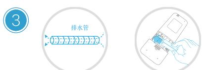
检查排水管是否通畅 将遥控器装上电池，检验通电
