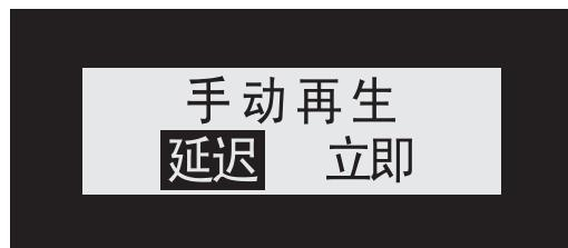
如用户临时需要再生，在待机状态下持续按确认键“■”3秒，可进入手动再生界面（如上图）选择“延迟”选项后，再按“□”键退出界面，系统将会在下一次再生时刻开始再生；如选择“立即”选项后，再按“□”键退出界面，系统将会立即开始再生。
