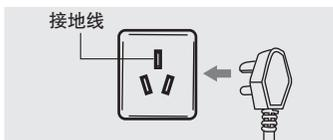
电源插座必须有可靠的接地线，用户不得擅自改动插头，严禁无接地运行。
