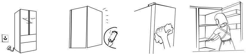
清洁时请勿使用硬质毛刷、钢丝球、钢丝刷、研磨剂（如牙膏）、有机溶剂（如酒精、丙酮、香蕉水等）、开水、酸碱性物品清洁冰箱。这有可能会损伤冰箱表面及内胆。
