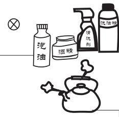
清洁时不要用水冲洗，以免影响电气绝缘性能。清洁照明灯和温控旋钮等电气件时请使用干抹布。
