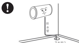
若连接排水管，应将排水管接于下水道口处，以免将室内溅污。
