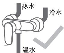
电热水器流出的热水有可能造成严重烫伤，请务必把热水与冷水混合后再进行洗浴或洗涤。
