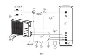
图 2-1 无电加热机组管道连接示意图
