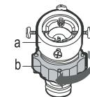
5.把进水管的另一端接到洗衣机背面的进水阀上。沿顺时针方向将管拧紧。
