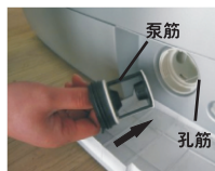
6. 清洗完后, 将泵盖装回泵空(泵筋务必对准孔筋)
