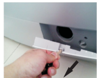
1. 用钥匙类的扁状工具打开过滤器门
