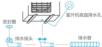
1. 将密封圈套入排水接头并卡紧。
