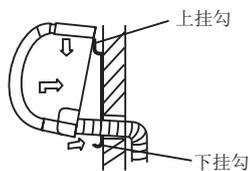
1. 将包扎好的管道及连接线穿过穿墙孔，并防止喇叭口损伤及泥沙进入连接管内。
