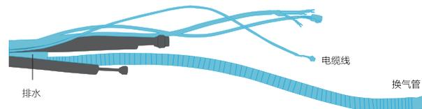
1. 将连接管直平铺在地板上 - 将排水管、换气管、各种电缆线（必须将两端的插接端口整理正确）铺在连接管周围。
