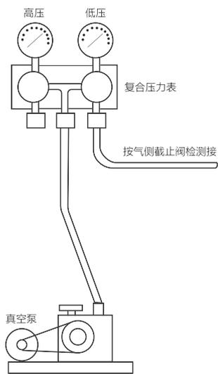
1. 连接软管与室外机（连接高、低压压力表和真空泵，图示）。
