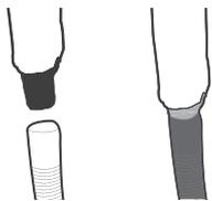
1. 将排水管与室内机排水管对接。
