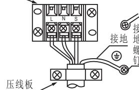
■将地线接在接地螺钉处，接地螺钉处的带齿垫圈须与电器安装板接触。
