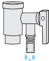
⚠ 单向安全阀泄压孔可能有水珠滴下，此属正常现象，若是大量漏水，请及时找专业人员维修。单向安全阀泄压孔出水的温度可能较高，人体不要接触，以免烫伤
