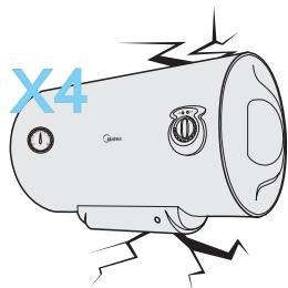
! 墙壁需承受电热水器注满水后四倍以上的重量才可安装，否则采取其他加强措施
