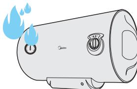
🚫 禁止在电热水器附近放置易燃易爆物品
