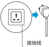
! 安装电热水器前必须检测和确认地线是否接地且安全可靠，且不能带电，否则请不要安装和使用。首次使用时，内胆在注满水之前，禁止接通电源
