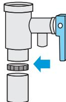
! 在单向安全阀与水管连接处应装上过滤网的密封圈，以免杂物进入引起堵塞；为使用安全，不可私自改动单向安全阀安装位置，且定期拉动手柄，去掉碳酸钙沉积物
