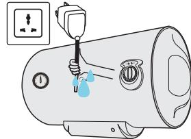
🚫 禁止用移动插座、破损电源线和插座；禁止湿手碰触插头、插座、遥控器，以防触电；禁止带电安装或维修
