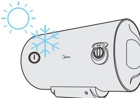
🚫 严禁将电热水器安装在室外；禁止将电热水器安装在高温物体和阳光直射附近；禁止安装在有结冰风险的区域
