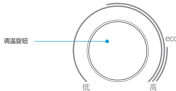
注：插好电源并通电后，电源指示灯亮，表示电热水器已通电但未进入加热状态，顺时针扭转调温旋钮，当温控器设定温度高于内胆水温时，加热指示灯亮表示开始加热；当内胆水温到达温控器设定温度时，加热指示灯熄灭，表示停止加热。
