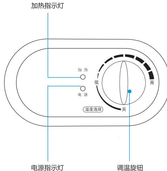
注：插好电源并通电后，电源指示灯亮，表示电热水器已通电但未进入加热状态，顺时针扭转调温旋钮，当温控器设定温度高于内胆水温时，加热指示灯亮表示开始加热；当内胆水温到达温控器设定温度时，加热指示灯熄灭，表示停止加热。
