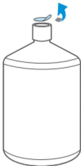
撕去水桶盖上的标签，用抽水组件盖或其它工具刺破桶盖。
