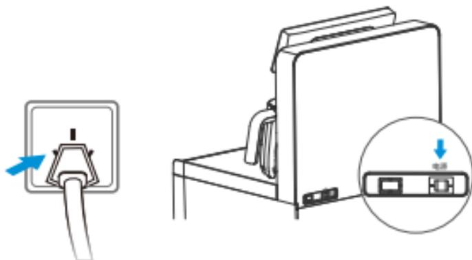
将电源插头插入插座内并打开机器背面的电源开关。
