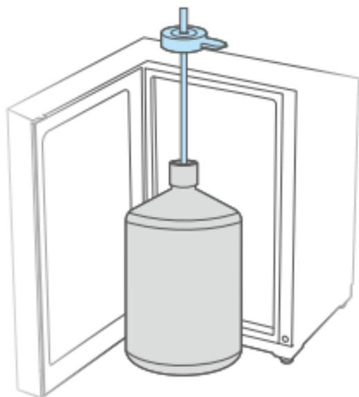
将机器内附带的抽水组件插入水桶盖孔中，并向下压直到卡住。
