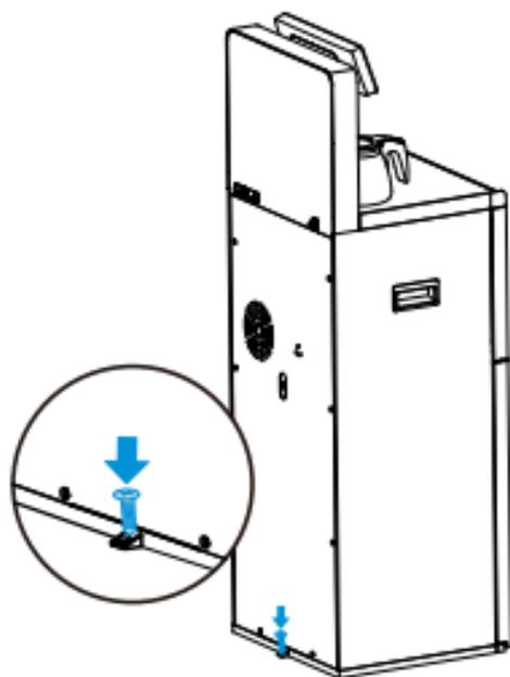
在图示位置打螺钉可将机器固定在地面上。
