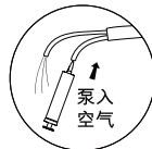
将排气筒插入水管 向水管内泵气排水
