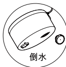
拧开主机密封盖 排水倒水
