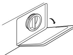
1.拔掉电源插头，打开过滤器门
