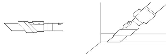
将二合一附件的毛刷头向后推，当听到“咔”声，即为固定住，即可清理墙角、楼梯、键盘等的缝隙。
