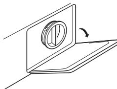
1. 拔掉电源插头，打开过滤器门
