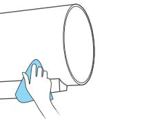
用湿布蘸取少量中性清洗剂轻轻擦拭，不要使用汽油、酒精或酸性溶液等化学溶剂。最后用干布擦干，保持电热水器干燥。
