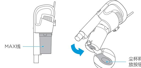
2. 用手捏住两边筋位将过滤器组件轻轻从尘杯组件中取出；
