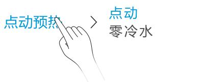
2 在用水端开关水龙头(热水端)或花洒(热水端)，在5S内完成启停2次，热水器启动 零冷水 。
