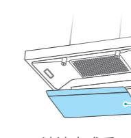
4. 用十字螺丝刀松开滤网左右两颗固定螺钉，双手扶住滤网沿水平方向取出。
