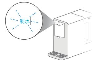
6. 首次使用时，制水完成后，对内部管路进行清洗：
