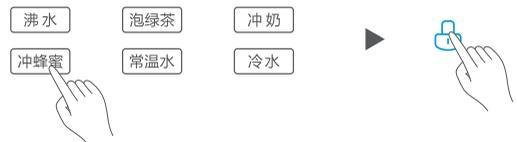
3. 再次点击水温图标停止出水。若2分钟内无任何操作，整机进入节能模式，所有按键熄灭。
