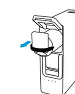
2. 更换滤芯前，首先关闭三通球阀，然后拔掉电源。
