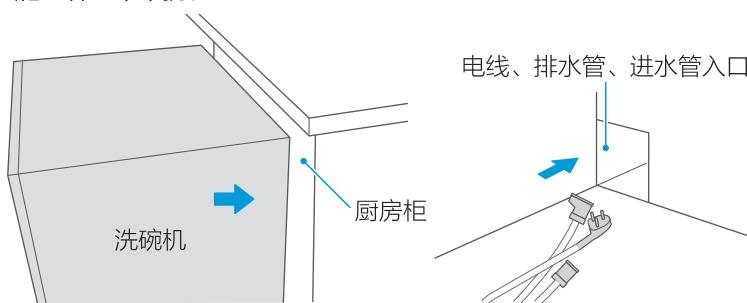
调整洗碗机高度直到洗碗机恰好够到厨房柜顶部，保持机身平衡。
