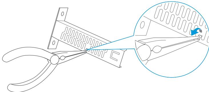
用钳子弯曲如图所示位置。（左右支架弯曲部位相反。）
