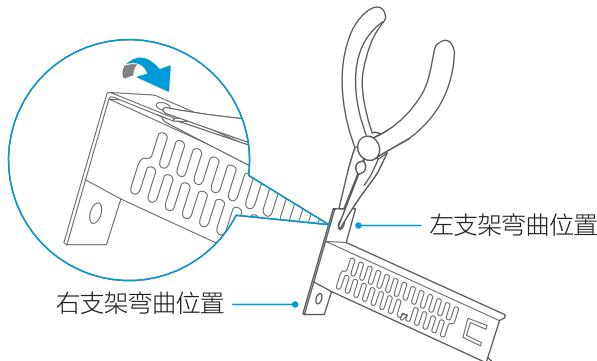
在左右两侧用ST4X14螺丝(4颗)安装踢脚板支架。（支架弯曲面向上。）并将踢脚板安装到洗碗机底部。
