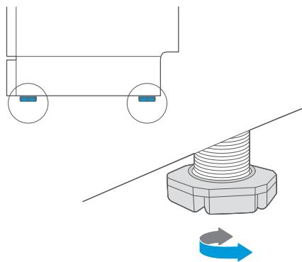
请先接通水电试运行，确保机器没问题后再固定机器。
