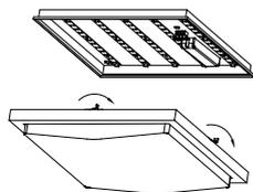
2) 用底盘在天花上合适位置确定孔位，在准确的位置钻孔，然后分别敲进膨胀胶钉。
