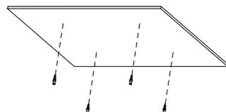
3) 将电源线穿过电源线孔，用螺钉将底盘固定在天花板上，然后按标识接好电源线，注意必须连接接地线，且保证接地可靠，确定无误后通电试灯。
