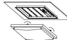
2) 安装面罩：将面罩放入边框，然后将边框套到底盘上，旋转卡扣将边框固定在底盘上，完成安装。
