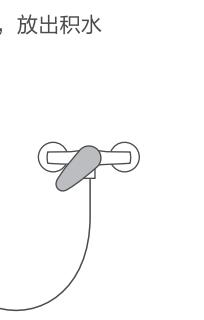
经常 (一般半年左右) 检查供气管道 (橡胶软管) 是否完好，有无老化、裂纹。注意定期更换橡胶软管，请经常用肥皂水在管路接口处检查有无气泡出现，判断是否漏气，若有漏气现象应立即解决。
