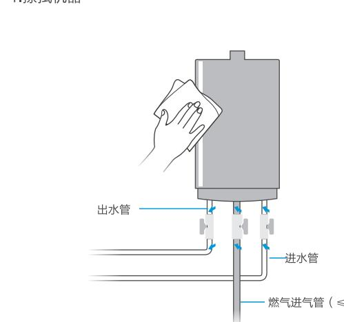
经常（一般半年左右）用柔软的清洁布擦拭机器外壳，可用清水和中性洗涤剂擦拭，禁止使用化学清洁剂或挥发性溶剂，否则外壳褪色并失去光泽。
