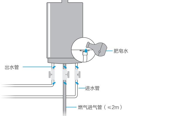
经常(一般半年左右)检查供气管道(橡胶软管)是否完好, 有无老化、裂纹。注意定期更换橡胶软管, 请经常用肥皂水在管路接口处检查有无气泡出现, 判断是否漏气, 若有漏气现象应立即解决。
