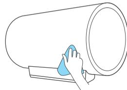
用湿布蘸取少量中性清洗剂轻轻擦拭，不要使用汽油、酒精或酸性溶液等化学溶剂。最后用干布擦干，保持电热水器干燥。
