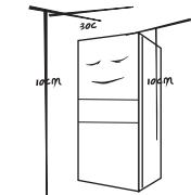
冰箱顶部空间大于30cm，两侧及背部与墙的距离大于10cm，便于冰箱门的开合和热量散发，用温湿抹布将冰箱内外擦干净（温水中可加少量洗涤剂，最后用清水擦净）。
