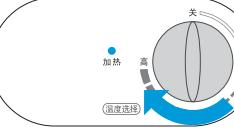
3. 当水温达到设置温度时停止加热，加热指示灯灭。水温下降到一定温度时会自动恢复加热。
