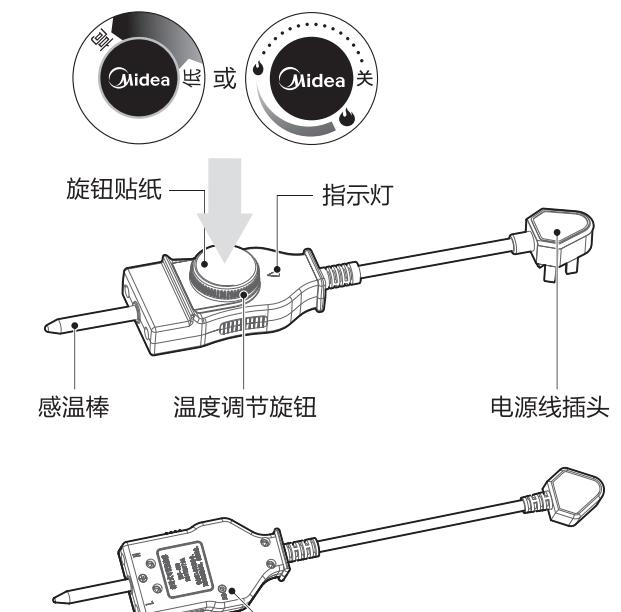
新调温棒采用可手动复位温控器,在背部有复位孔,当温度异常导致温控器跳断时,可在调温棒断开电源情况下通过针状物按压此复位孔的按钮,恢复正常使用。
