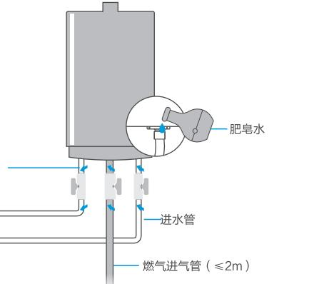
经常（一般半年左右）检查供气管道（橡胶软管）是否完好，有无老化、裂纹。注意定期更换橡胶软管，请经常用肥皂水在管路接口处检查有无气泡出现，判断是否漏气，若有漏气现象应立即解决。
