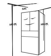
冰箱顶部空间大于30cm，两侧及背部与墙的距离大于10cm，便于冰箱门的开合和热量散发，用温湿抹布将冰箱内外擦干净（温水中可加少量洗涤剂，最后用清水擦净）。
