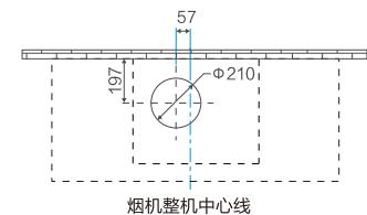
吊顶处排烟管开孔尺寸示意图
