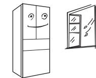
将冰箱放置在室内通风良好的地方，地面平坦、坚固（如有不平稳，可向左或向右旋转调平脚调平）。
