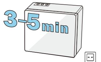
若长时间不使用本产品，请关闭电源和三通球阀。再次使用时，应先放水3-5分钟才能正常使用
