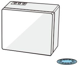
请将机器安装在尽可能靠近地漏处
