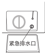
2.向左或向右旋转90° 拉出紧急排水管,拔下紧急排水导管盖
