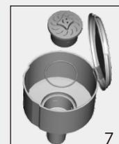
将密封圈放在上桶内部凹槽中，将滤芯组件旋入上桶，(注意请勿丢失密封圈)
