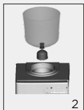
旋开饮水机的聪明座，将下桶底部放入饮水机的分水池
