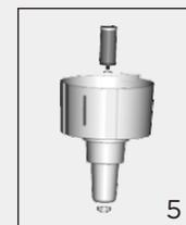
将PP棉滤芯通过螺母安装在上桶底部
