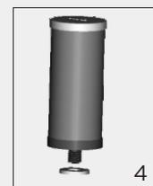
将密封垫圈安装在PP棉滤芯上
