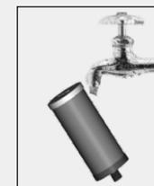
将PP棉滤芯放在水龙头下冲洗，直至表面冲洗干净。
