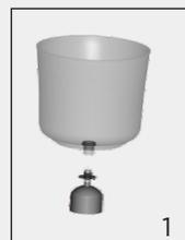
将浮球组件的连接螺母旋进下桶的密封盖中
