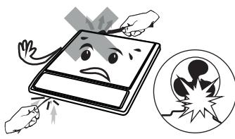
③ 请勿以纸张、铝箔纸、布等无关物品垫在灶面板上间接加热，以免产生意外。
