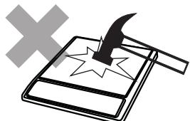
▲ 电磁炉的灶面板承重有限，不要放过重的东西在灶面板上，否则会导致塑料面盖及灶面板损坏。
