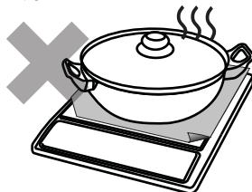
④ 电磁炉不允许放在任何金属（铁质、不锈钢、铝质等）平台上使用。
