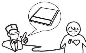
④ 使用时，电磁炉应水平放置，侧面、背面与墙要有10cm以上的距离。请勿将电磁炉放在狭窄的空间内使用，不要被异物挡住吸排风口而影响散热。
