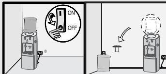
1、关闭饮水机加热、制冷开关，
