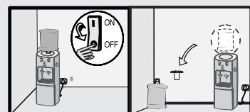
1、关闭饮水机加热、制冷开关，
